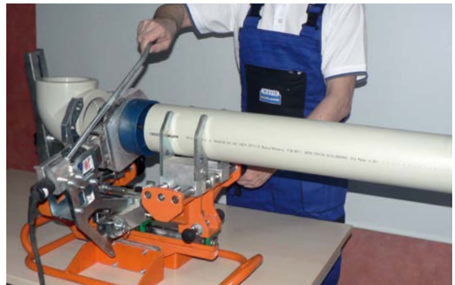
закрепление в аппарате и центровка, потом нагрев
